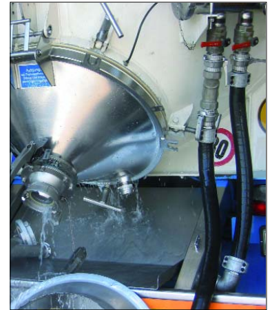
Druckluftschläuche an Silofahrzeugen – hier rechts im Bild – unterliegen nicht der Druckgeräterichtlinie.
